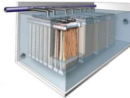
Equipos de UF (membranas de fibra ción)
